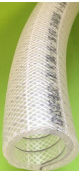
**CONSTRUCTION :** Tube lisse thermoplastique, spirale inox. Le procédé de fabrication exclut la vulcanisation et donc les risques de trouver des résidus de peroxyde et platine dans le produit fini. Production limitant l'émission de CO<sub>2</sub>.
