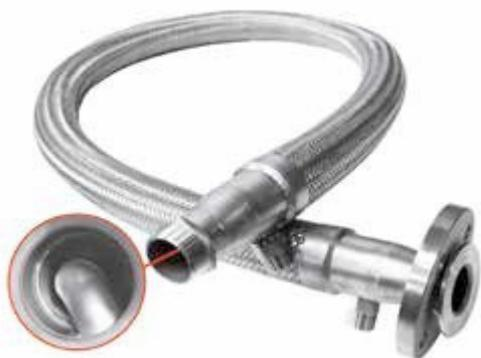
Le flexible traceur permet de maintenir en température le fluide process grâce au flexible caloporteur qui se situe à l'intérieur de son passage.
