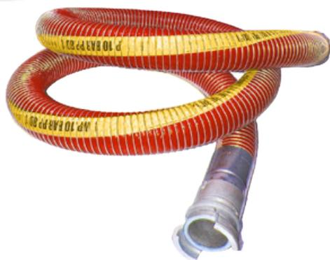
**CONSTRUCTION:** Film PTFE entouré de plusieurs couches thermoplastiques avec spirale de renfort interne inox 316. Revêtement extérieur polymère rouge résistant aux intempéries avec spirale de renfort inox 316.
